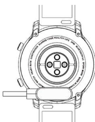
**⚠️** El contacto simultáneo de las dos clavijas del cable USB y el conductor puede provocar un cortocircuito y quemaduras.
