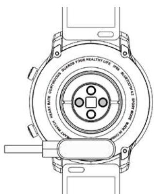
**⚠️** Il contatto simultaneo dei due pin del cavo USB e del conduttore può causare un cortocircuito e provocare ustioni.
