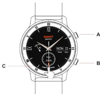
**A:** Presione el botón para volver a la interfaz de la pantalla desde la interfaz de funciones; presione el botón para encender/apagar la pantalla cuando esté en la interfaz de la pantalla. Mantenga presionado el botón para encender/apagar el reloj inteligente.
